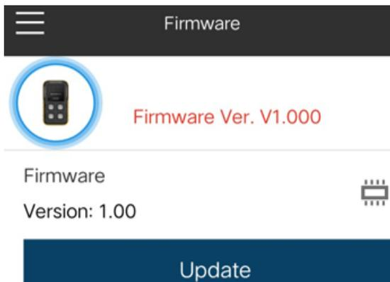
5. Toque **SÍ** para comenzar la actualización de firmware y espere hasta que se muestre el mensaje de sistema "Actualización exitosa". Una vez que haya configurado la fecha, el detector pasará al modo Normal.
